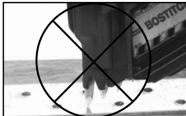
Mauvais placement du clou
